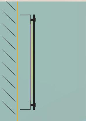
Unterkonstruktion aus abgekantetem Aluminiumblech in Edelstahloptik.
