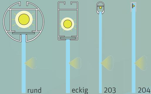
Eine sehr effektvolle Lichtwerbung kann mit Lichtflutern erreicht werden. Hier erstrahlen eingravierte Buchstaben, Schriften, Sinnbilder u. a. figürliche Darstellungen auf Acrylglasscheiben. Dieser Effekt entsteht dadurch, dass die Lichtquelle selbst nicht sichtbar ist. Die Werbewirkung zielt auf den Nahbereich und ist von einer zurückhaltenden eleganten Ausstrahlung.
